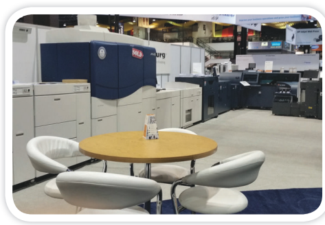
Presse d'impression numérique Xerox iGen™ 150 travaillant en ligne avec un margeur de feuilles Bourq (BSF), un module Bourq de perforation rotation pliage (BPRF), un thermoreducteur Bourq BB3202 et un massicot tri-lames CMT-330C
